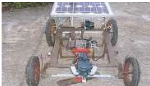
ภาพที่ 1 แสดงภาพด้านหน้ารถตัดหญ้าพลังงานแสงอาทิตย์ควบคุมด้วยวิทยุบังคับ ที่มา: (จิวัฒน์ ตั้งวันเจริญ,2560)
