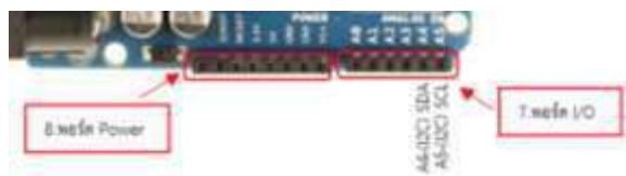
ภาพที่ 2.21 ส่วนประกอบของบอร์ด Arduino
