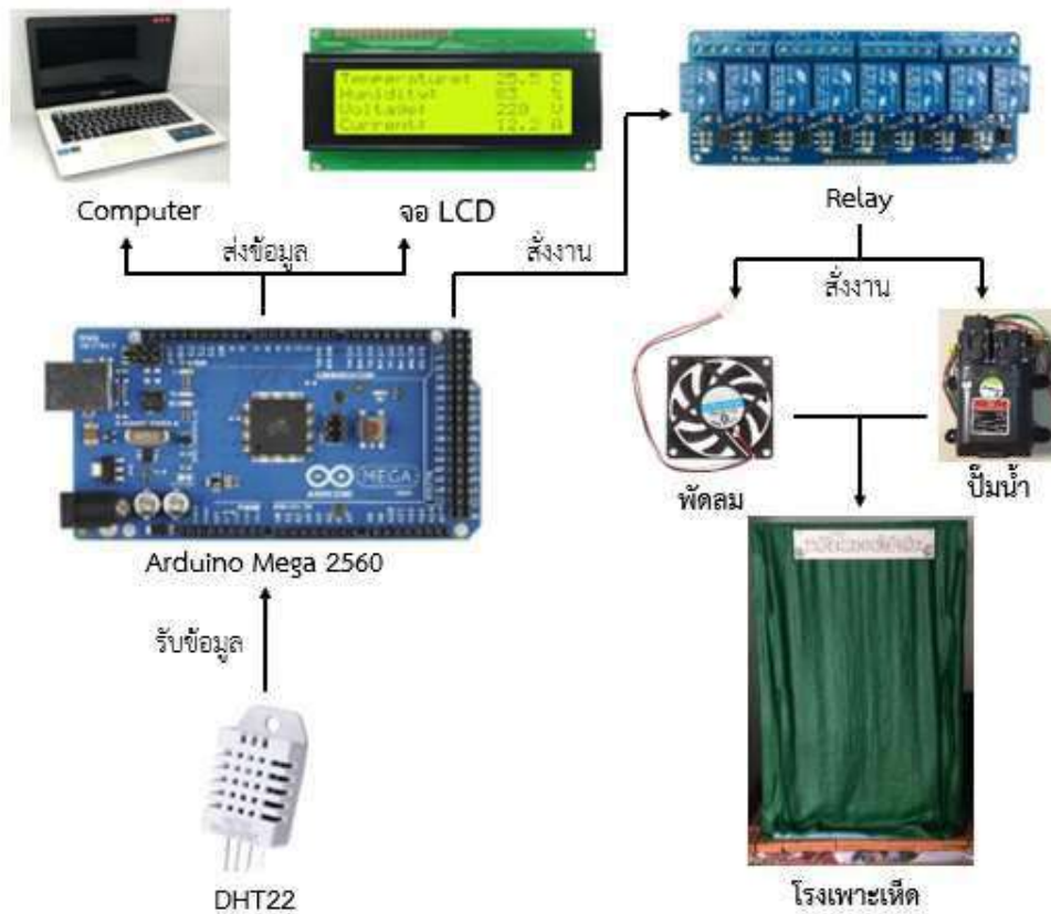
รูปที่ 11 แสดงระบบควบคุมอุณหภูมิและความชื้นแบบอัตโนมัติโดยใช้ไมโครคอนโทรลเลอร์ Arduino
