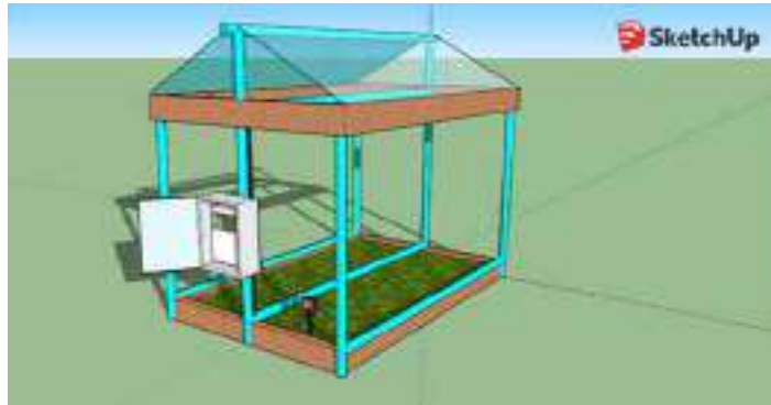
ภาพที่ 11.2.2 ชุดจำลองระบบลดอุณหภูมิในโรงเรือนและการรดน้ำผักกางต้งอัตโนมัติ (ที่มา : ธิติวุฒิ ศรีกัน,2563)
