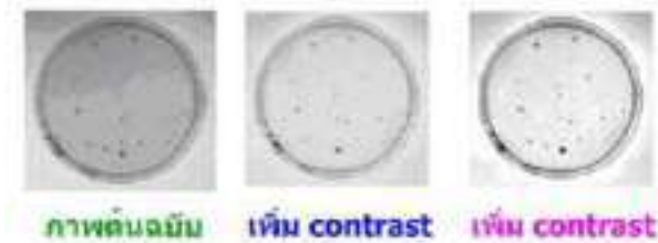
ภาพที่ 10.2.1 แสดงการหาเชื้อแบคทีเรียโดยใช้หลักการของการประมวลผลภาพ
