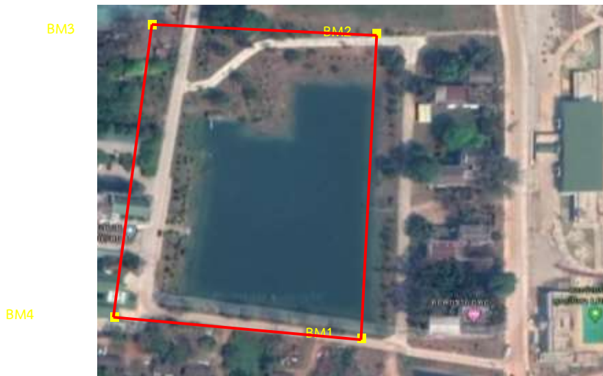
ภาพที่ 3.2 การสร้างหมุดรอบอ่างเก็บน้ำมหาวิทยาลัยราชภัฏเลย
